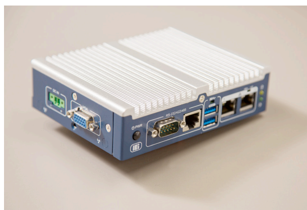
Der Energiedatenlogger erfasst Messwerte und macht Energieflüsse auswertbar.
